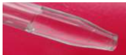
Unidirectional method grown \text{Li}_2\text{SO}_4 \cdot \text{H}_2\text{O} crystal
